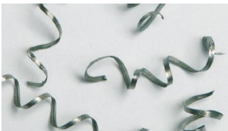
Enrollamiento moderado: condiciones de corte correctas
