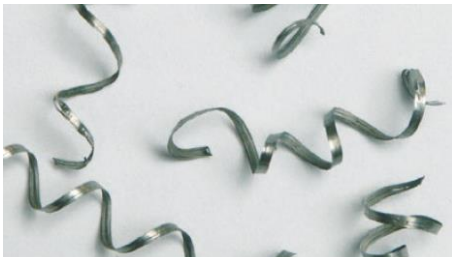
Enrollamiento moderado: condiciones de corte correctas
