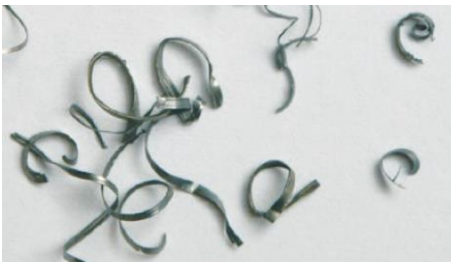
Virutas muy finas o pulverulentas: avance insuficiente
