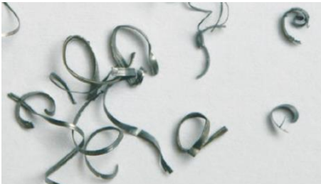
Copeaux très fins ou poudreux : avance insuffisante
