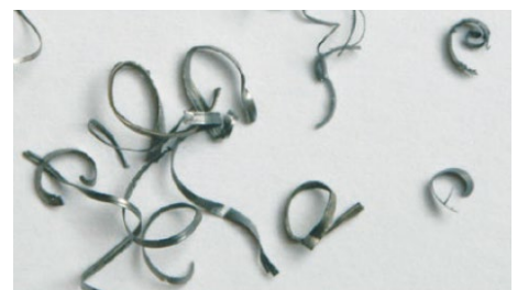
Des copeaux très fins ou poudreux indiquent une avance insuffisante
