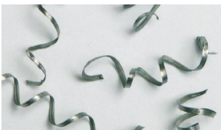
L'enroulement modéré des copeaux indique des conditions de coupe correctes
