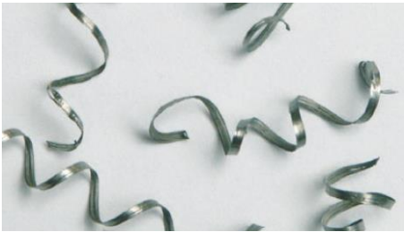
Enroulement modéré ; conditions de coupe correctes
