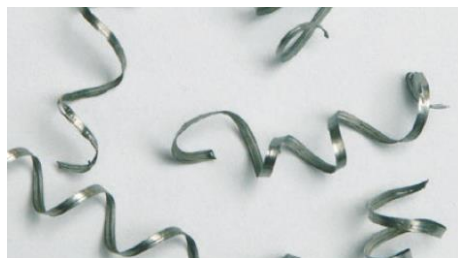
Enrollamiento moderado: condiciones de corte correctas
