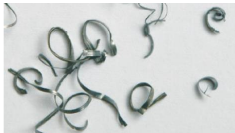
Virutas muy finas o pulverulentas: avance demasiado bajo
