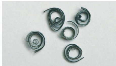
Enrollamiento muy apretado o con tonalidades azuladas: avance demasiado alto
