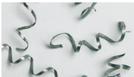
Enrollamiento moderado: condiciones de corte correctas
