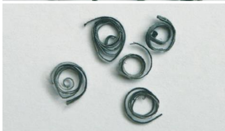
Enrollamiento muy apretado o con matices azulados: avance demasiado alto
