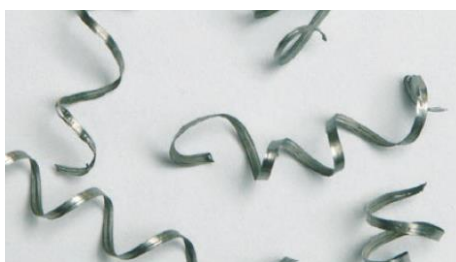
Enrollamiento moderado; condiciones de corte correctas
