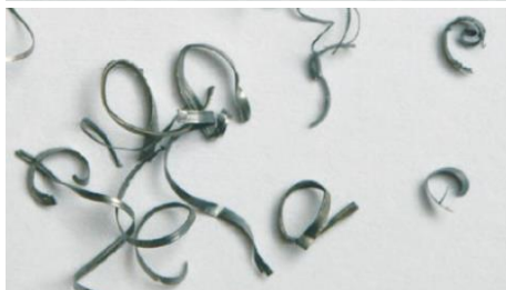
Virutas muy finas o pulverulentas: avance insuficiente
