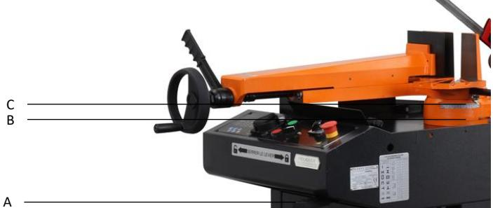
**Bloquer fermement le levier de serrage d'archet afin d'éviter que l'archet ne change de position pendant la coupe.**
