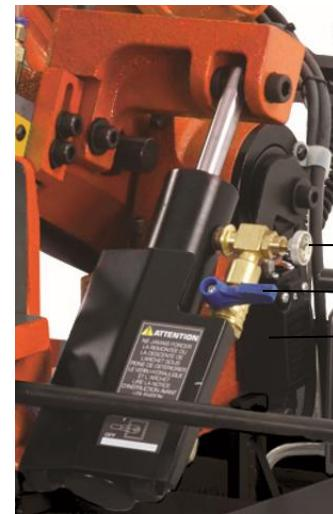
**Ne jamais forcer la remontée ou la descente de l'archet sous peine de détériorer le vérin hydraulique et l'archet.**
