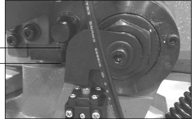
**! La vis de butée ne doit pas être serrée trop enfoncée, car, dans ce cas, le ruban découperait le fond d'étau.
