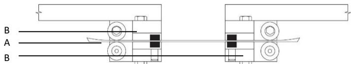
Le réglage des roulements et des guides ruban influe principalement sur la durée de vie du ruban et la qualité de la coupe.
