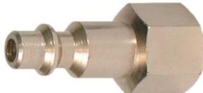
Raccord automatique à bague intégrant un mécanisme de verrouillage à 6 billes en acier inoxydable, Etanchéité maximale du circuit, Connexion et déconnexion rapide par bague coulissante, Pression de service : 0 -16 bar Température de service : -15°C + 80°C
