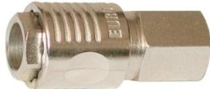
Raccord automatique à bague intégrant un mécanisme de verrouillage à 6 billes en acier inoxydable, Etanchéité maximale du circuit, Connexion et déconnexion rapide par bague coulissante, Pression de service : 0 -16 bar Température de service : -15°C + 80°C
